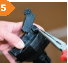
Replace the pivot pin.
